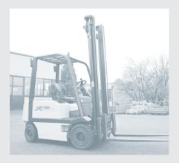
Новое оптимизированное **шасси**, разработанное на основе самых передовых методов вычисления конечных элементов F.E.M. (Finite Elements Methods), позволило получить большую жесткость при кручении.
