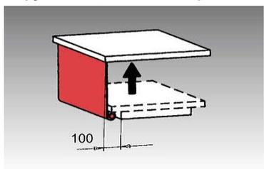
**Наклонная поверхность платформы (маж угол - 35°)**
